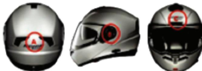
Se debe medir la velocidad de impacto. Se registra la desaceleración de la horma contra tiempo y se registra la máxima desaceleración registrada; si esta en cada uno de los dos impactos es menor a 306 g, el casco aprueba el ensayo. Una referencia aprueba el ensayo si todos los seis cascos registran menos de 306 g en cada uno de los impactos.
